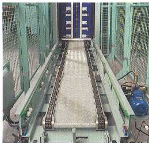
Automatische Übergabestation für Rollcontainer an eine automatisierte Entlastation
